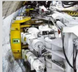
以特定的钻孔布置方式来安装锚杆，在陡峭的陡坡进行隧道掘进时，设备两侧的撑靴还可用来固定设备。
